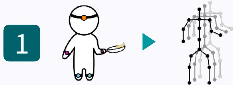
慣性式モーションキャプチャのmocopiを用いて 骨格情報(BVH形式)を得る
